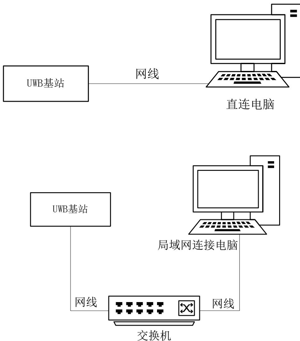
图 6-1 模块连接 PC 示意图
